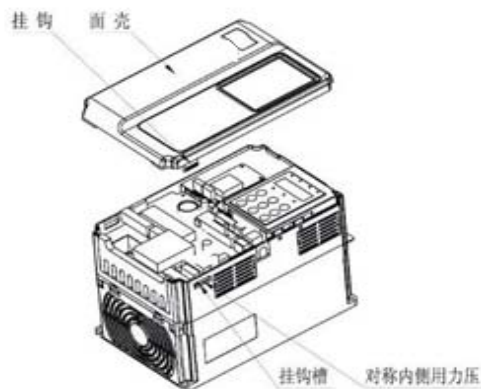
图 3-3 塑壳机箱下面板的拆卸
