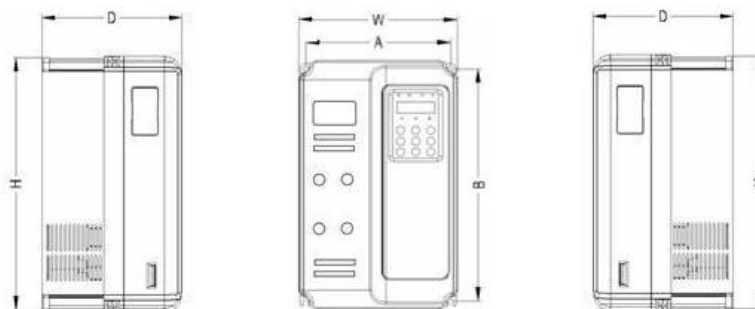
图 2-4 AD1000 系列塑件结构外型尺寸及安装尺寸示意图
