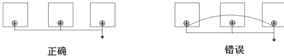
图 3-5 接地线接法示意图
